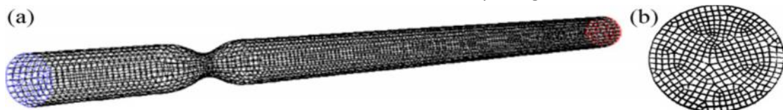
Figure III.3. (a) grille 3D modèle de sténose, (b) Coupe transversale du maillage.
